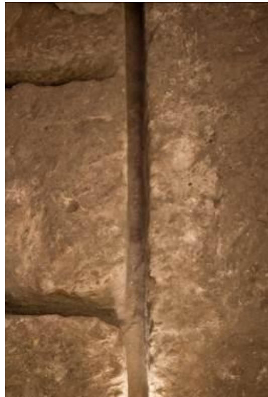
Fig. 4 - Dettaglio di alcuni blocchi pronti per l'estrazione (foto di Unicity S.p.A.).
