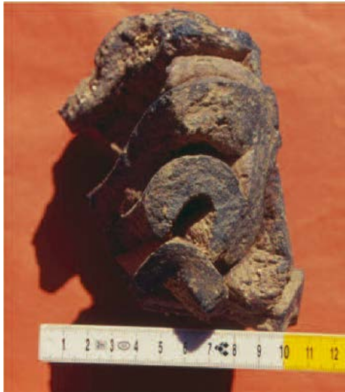
Fig. 2 - Château de Baldu, briques déformées et fondues durant la cuisson (Pinna, Corda a c.d.s., p. 152 fig. 10).
