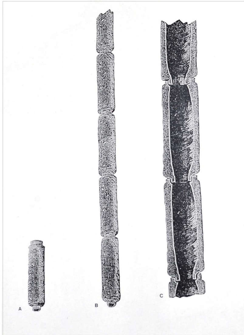
Fig. 4 - Dessin reconstruisant la perspective et la section d'une conduite réalisée avec des tubes en terre cuite (photo Unicity S.p.A.).
