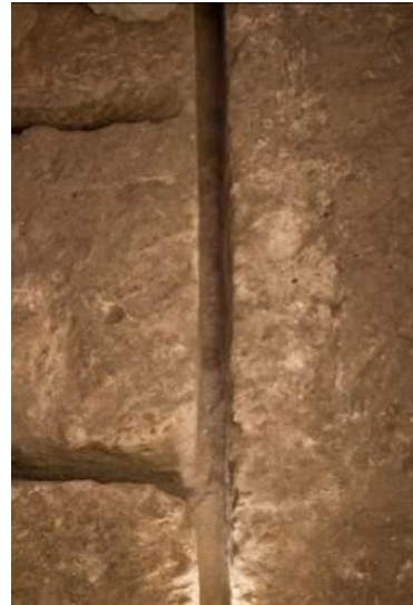
Fig. 4 - Detalle de algunos bloques listos para su extracción (foto de Unicity S.p.A.).
