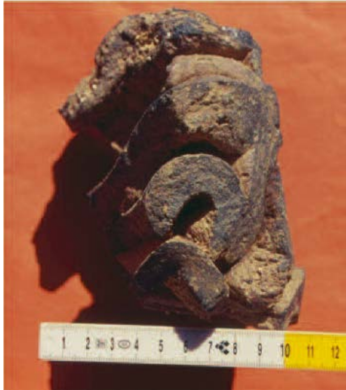
Fig. 2 - Palazzo di Baldu , material de terracota deformado y fundido durante la fase de cocción (de PINNA, CORDA, en impresión, pág. 152 fig. 10).
