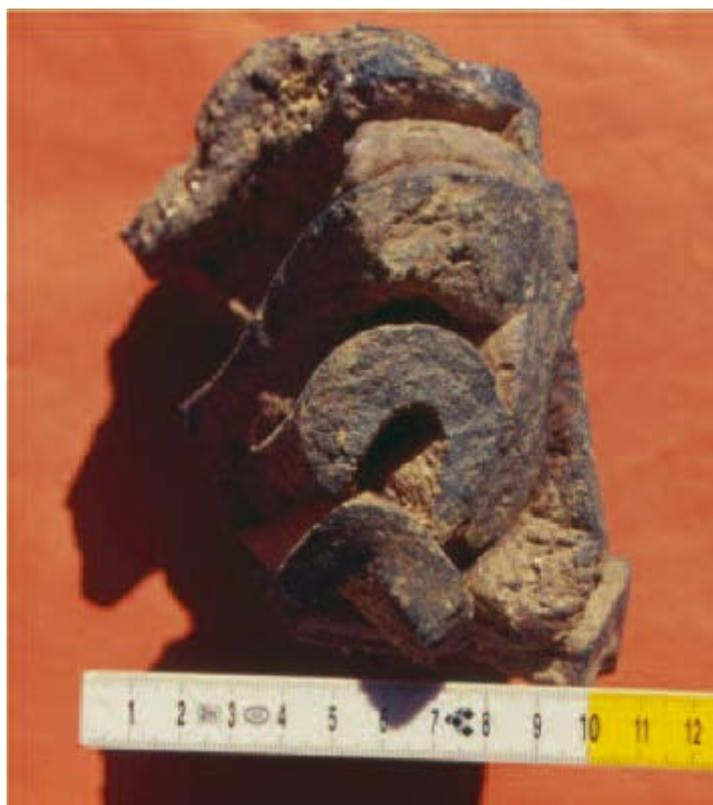
**Fig. 10** - Palazzo di Baldu, laterizi deformati e fusi insieme in fase di cottura
